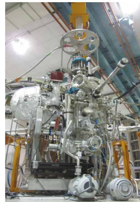
高輝度低エネルギーシンクロトロン光源UVSOR-IIIに設置した物質の機能性の起源である電子構造を詳細に調べることができる光電子分光装置 (SAMRAI)。
