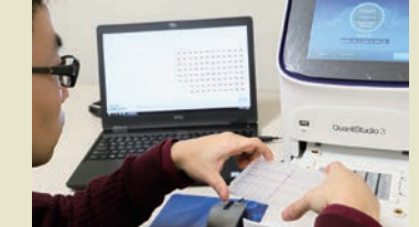
リアルタイム PCRシステム PCR反応による増幅を蛍光色素を用いて経時的に検出、増幅率に基づき鋳型DNAを定量 Real-time PCR system QuantStudio 3 By measuring the amplifications of PCR using a fluorescent dye, the amount of template DNA is quantified.
