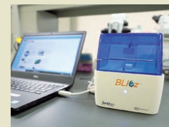
タンパク質パーソナルアッセイシステム 生体分子の相互作用解析、タンパク質定量する機器 Protein personal assay system: BLitz For biomolecular interaction analysis / protein quantification
