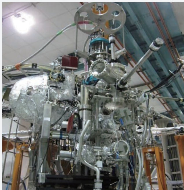
物質の機能性の起源である電子構造を詳細に調べることができる光電子分光装置 (SAMRAI)
