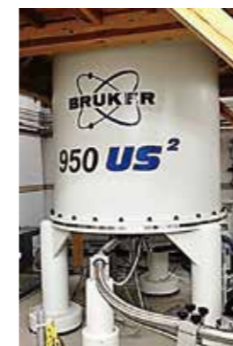
超高磁場 NMR 装置 (950MHz) 950 MHz Ultra high-field NMR
