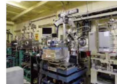
SPring-8の生体超分子複合体構造解析ビームライン(BL44XU) Synchrotron radiation beamline for supramolecular crystallography at SPring-8(BL44XU)
