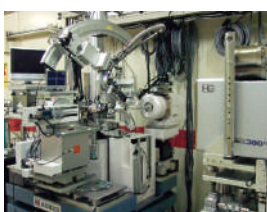
SPRING-8の生体超分子構造解析ビームライン(BL44XU) Synchrotron radiation beamline for supramolecular crystallography at SPRING-8 (BL44XU)
